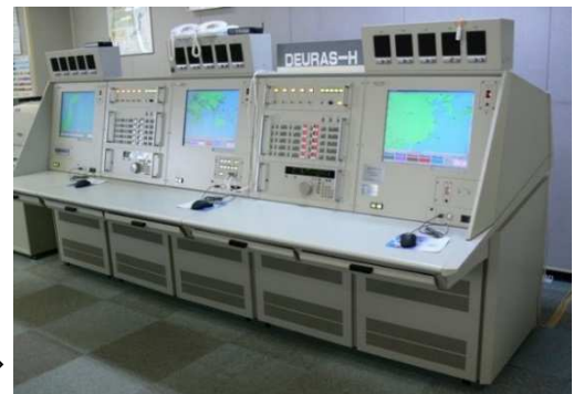
▲三浦電波監視センター (神奈川県三浦市) 電波発射源探知装置「DEURAS-H」⇒
